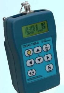
В комплекте с источниками оптического излучения модельной группы (модификации) «ТОПАЗ-710X-А» измеритель мощности позволяет проводить автоматические измерения затухания волоконно-оптических линий связи (ВОЛС).
